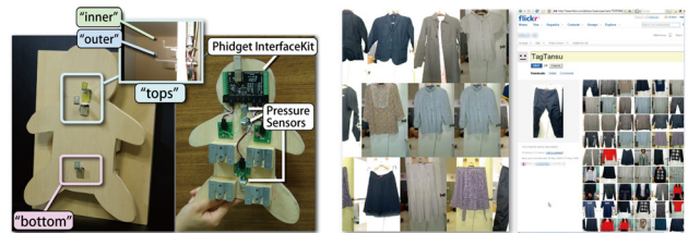
図10 フックセンサーの外観、および撮影画像とFlickrとの連携
