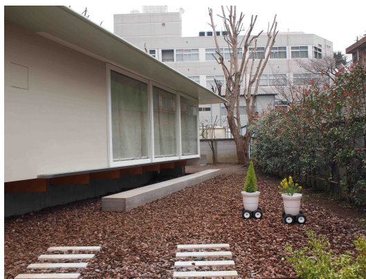
図 1. PotPet: 植物をのせて自律的に動くペットのような植木鉢型ロボット
