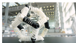
3Dプリンタを用いた弾力調整可能な コイルスプリングジョイント機構
