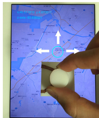
図 14 俯瞰視点モード。マーカを浮かせた状態で水平/垂直方向に移動させることで、地図を移動させる。
