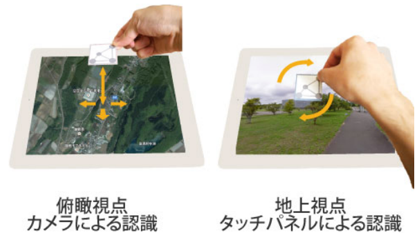
図 13 視点の切り替えが可能な地図アプリケーション。マーカを浮かせた状態と接地させた状態で、GoogleマップとGoogleストリートビューを切り替える。
