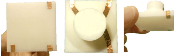
図 11 立体形状のつまみ。左：底面，中央：俯瞰した面，右：側面。底面に2次元コードを接着させていない状態。
