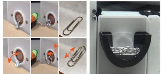
図19 左：ネジ/キーホルダ/クリップへの試験的な適応。矢印方向への周期的な動きを確認した。右：小物用固定具のプロトタイプ
