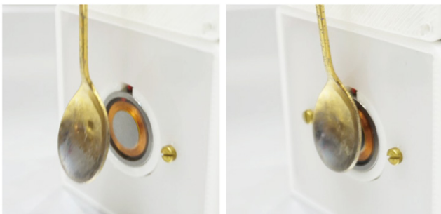
図3 音生成の仕組み。吊り下げた日用品（左）に対し磁力を発生させて電磁石に吸着させ（右）、接触音を発生させる。
