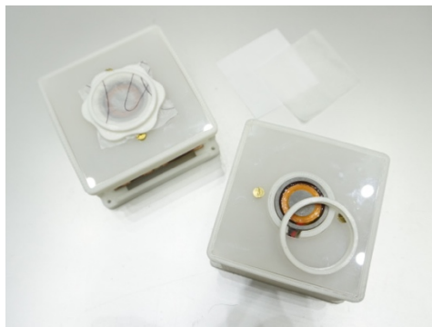
図4 素材変更の仕組み。ティッシュやビニール等の薄い素材を置き、キャップではさんで固定する。
