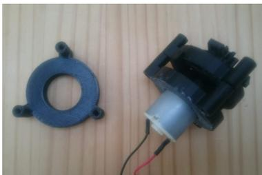
図 11 モーター固定用パーツと利用例, 1:4 の遊星ギアに接続している。
