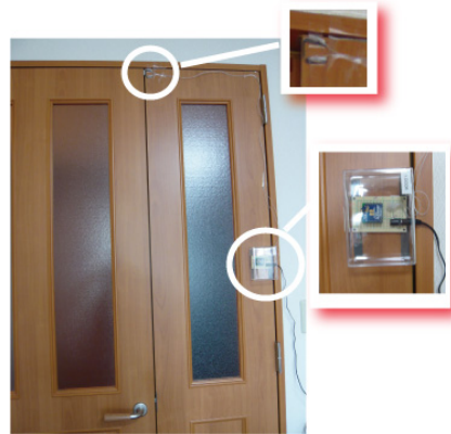
図 10 リビングのドアにリードスイッチ (上) と無線モジュール (下) を取り付け
