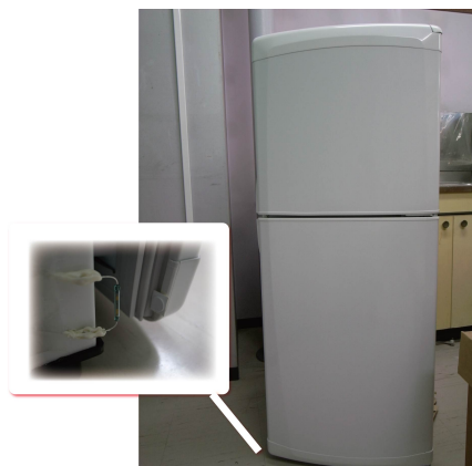
図 8 冷蔵庫の扉にリードスイッチを取り付けた
