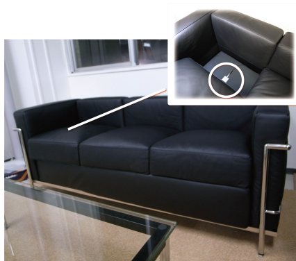
図 6 ソファーマットの下の，3 か所に圧力センサを取り付けた
