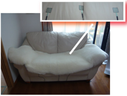
図 11 ソファに圧力センサと無線モジュールを取り付けた
