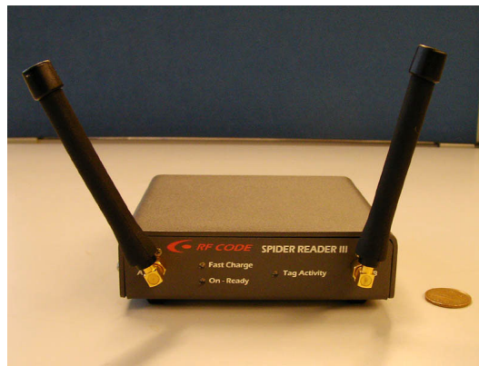
図 A.5: アクティブタイプのリーダー (RF Code Spider Reader 6 )
