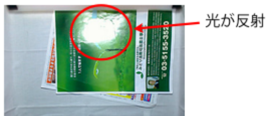
図 10 誤判別の例 2 : 光の反射により広告チラシが手紙と誤判別された。
