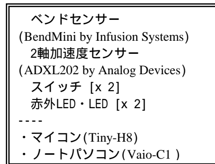
図 4 プロトタイプのシステム構成
