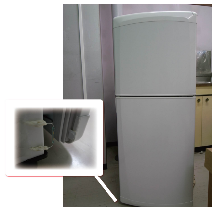
図 10. 冷蔵庫の扉にリードスイッチを取り付けた
