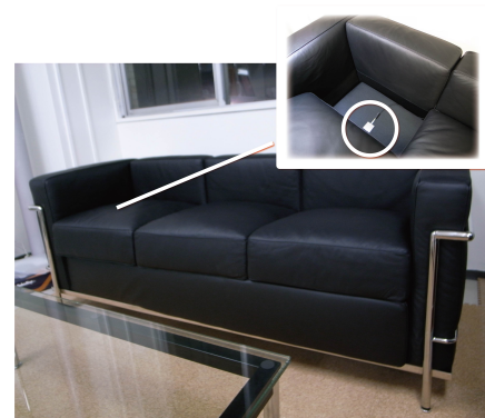
図 7. ソファーマットの下，3か所に圧力センサを取り付けた
