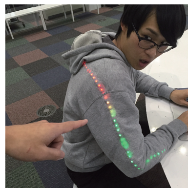
図 1 StandOuter の概要。ユーザの姿勢の悪化を検出し、ユーザ自身と周囲の第三者に分かる形で強調して光の変化で提示する。
