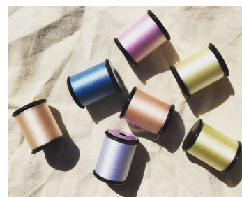
図 2 本研究で使用する UV 刺繍糸[a]。黄、オレンジ、ピンク、青、赤、紫、緑の 7 色。写真は紫外線で変色後の色であり、変色前は全て白色である。
