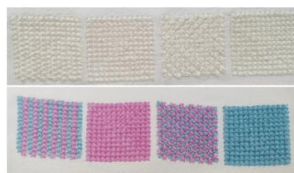
図 3 2 色の混色例。上：紫外線照射前、下：紫外線照射後。左から縦ストライプ、ピンク単色、斜めストライプ、青単色。縫い設定はクロスステッチ。
