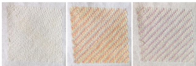
図 9 4 色のキャンバス。左から紫外線照射前、紫外線照射機で照射したもの、手持ちライトで照射したもの。
