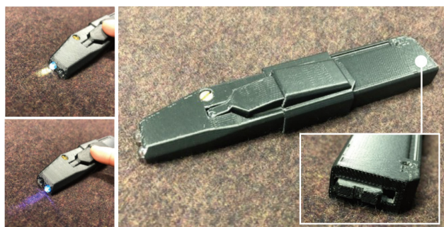
図 16 UV ペンのプロトタイプ外観．ペンの背にあるスライドスイッチで 2 種類の波長の紫外線 LED を切り替える．
