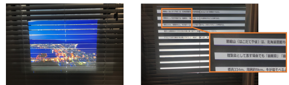
図8 両面で異なった情報を提示するコンテンツの一例。内側（左）では、聴衆側用にスライドなどを表示しつつ、外側（右）では話者側用の読み原稿を表示できる。
