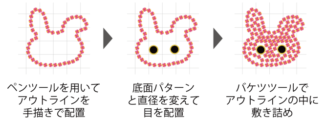
図 7 レイアウト支援システムの利用例。顔のパターンは直径 3mm, 目のパターンは直径 7.5mm とした。
