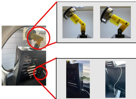
図 5 リアガラスへの取り付けと電源供給
