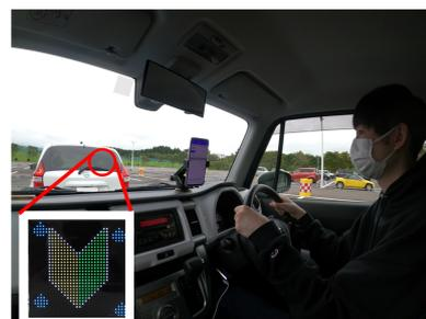
図1 スマートステッカーの活用例。後続車のドライバー等に車内の状況等をインタラクティブに提示する。
