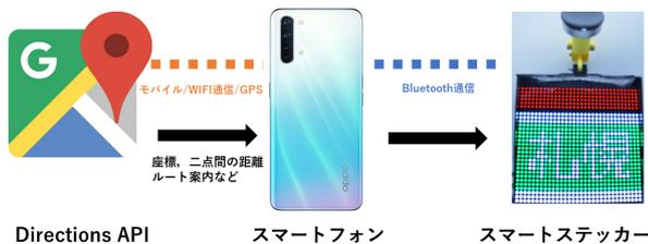
図 9 行先表示ステッカーのシステム構成
