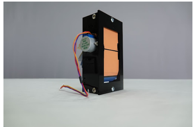
図 4 フラップ機構単体の外観
