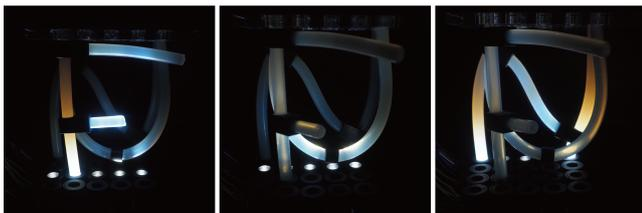
図 11 ネオンサインで文字を表現するイメージ。「FUN」を 1 文字ずつ切り替えて点灯している。
