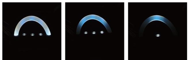
図 13 アーチの LED の点灯箇所を変化させた様子 (○: LED 点灯, ●: LED 消灯)。
