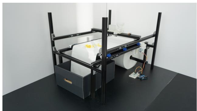
図3 自動培養装置のプロトタイプ
