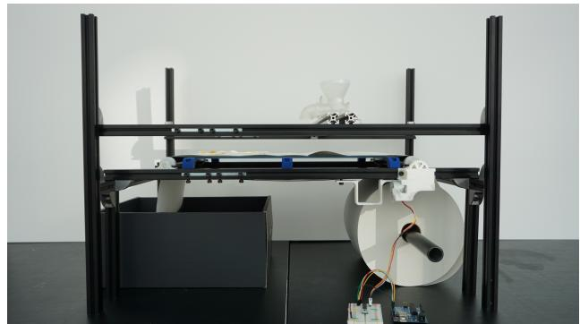
図4 自動培養装置のプロトタイプ(側面)
