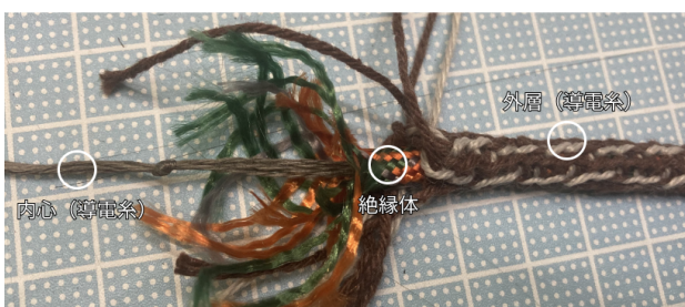
図 8 2 層組紐の構造と制作例
