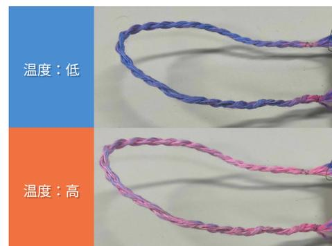
図 17 ニクロム線の温度と組紐の色変化
