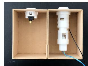
図 23 押しボタンの高さの比較。左はユーザ評価に用いた OBSF-30、右は本研究の押しボタン型デバイス
