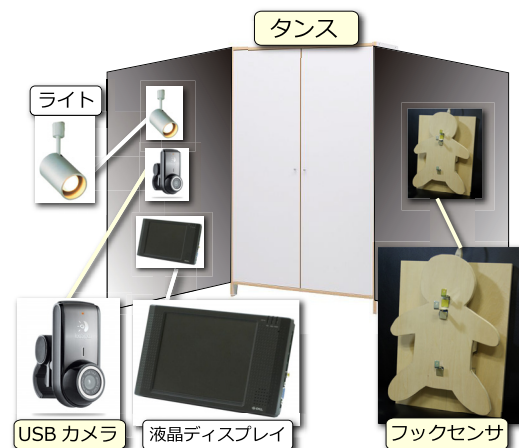
図 1 タグタンスの基本コンセプト. タンスの両扉の内側を使い, 片側に USB カメラ, 照明, 液晶ディスプレイを, もう片側にはフックセンサを設置する. フックに重さがかかるとフックの下に装着された圧力センサが反応し, 撮影が行われる.
