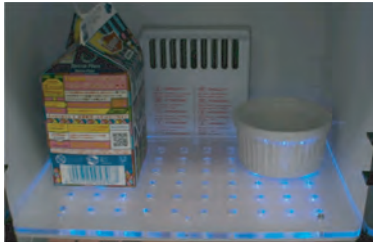
図 6 LED を用いた情報提示の様子。各 LED が異なる周期で点灯する
